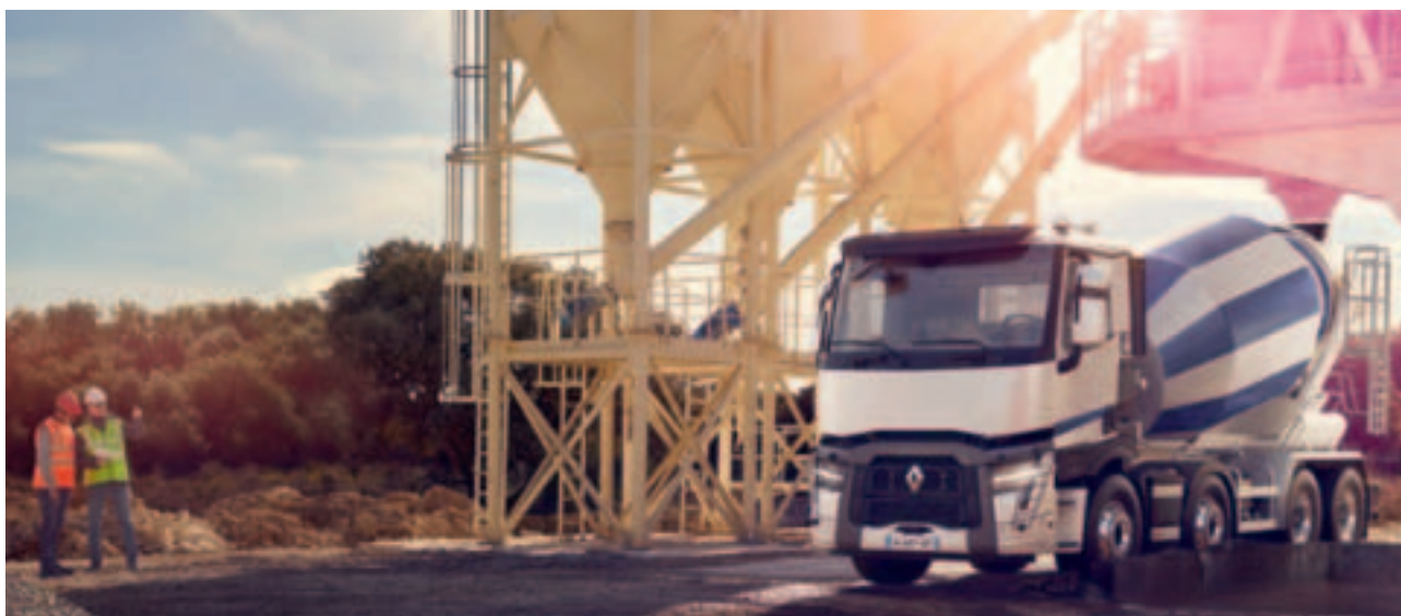
Бетономішувач на шасі С XLOAD 8x4 порожньою масою 9200 кг.
