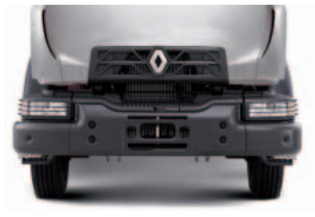
100% СТАЛЕВИЙ БАМПЕР (D) для експлуатації у складних умовах.
