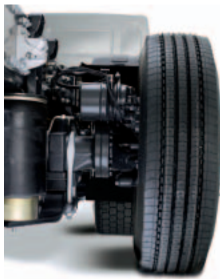
ЗАДНІ ПНЕВМОПІДВІСКИ ШАСІ для ще більшої стійкості та кращого захисту вантажів.
