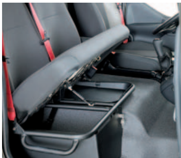
ВІДДІЛЕННЯ ДЛЯ РЕЧЕЙ ПІД БАГАТОМІСНИМ СИДІННЯМ завдяки сидінню, що підіймається.
