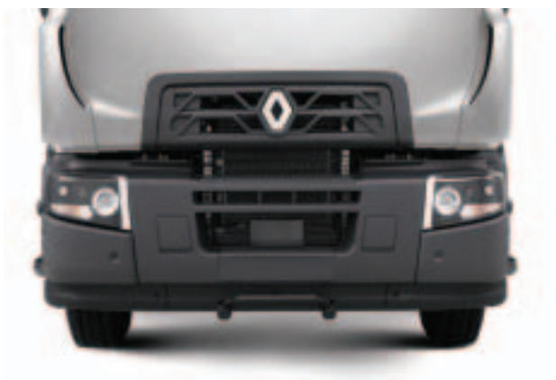
БАМПЕР ІЗ СТАЛЕВИМИ КУТАМИ (D) для більшої надійності.
