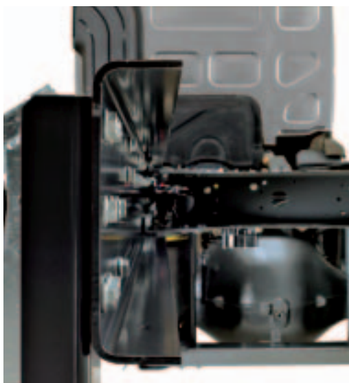
ЛОНЖЕРОНИ ШАСІ зі сталі з високою межею пружності.
