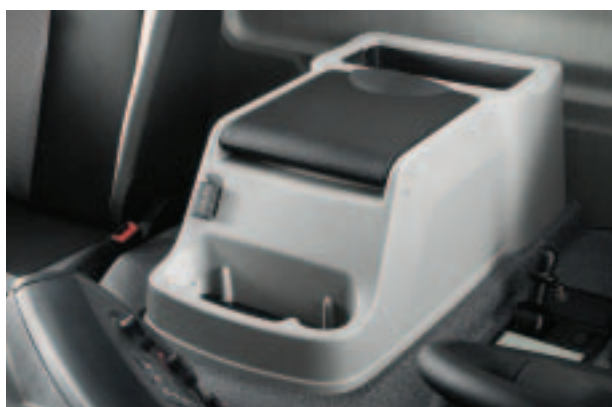
ЦЕНТРАЛЬНЕ ВІДДІЛЕННЯ ДЛЯ РЕЧЕЙ з об'ємом у 15 л, відкидним столиком, утримувачем для пляшок, утримувачем склянок, додатковим джерелом живлення 24 В.
